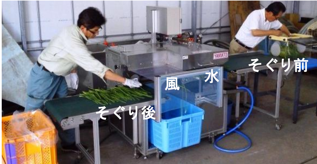
写真 水圧式ニラ洗浄そぐり機(そぐり機)を用いた試験風景
