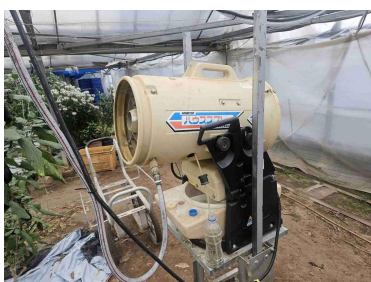
常温煙霧機の設置状況
