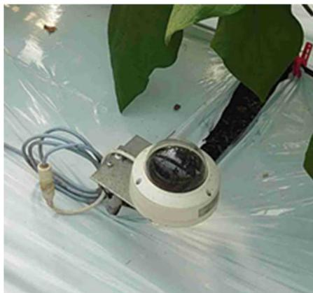
図8 IPカメラのうね上への設置状況
