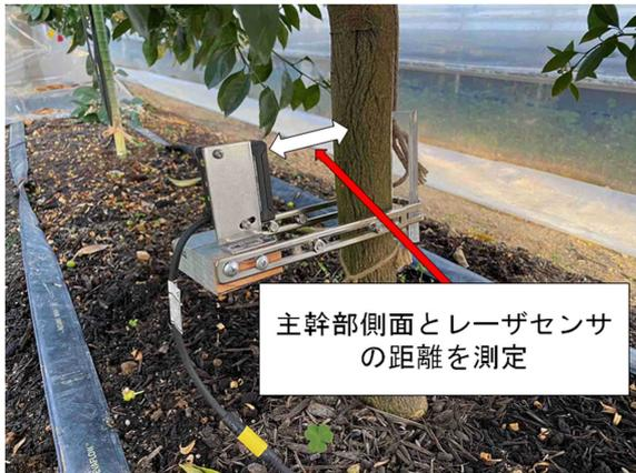
写真 レーザセンサ設置の様子
