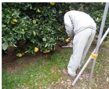
プラントキャノピーアナライザー(PCA)による「土佐文旦」でのLAIの測定
