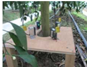
幹肥大の測定 (反射型レーザーセンサ)
