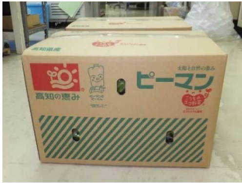
図3 段ボール箱の膨らみ (手前；20 \mu m-OPP、奥；25 \mu m-CPP)
