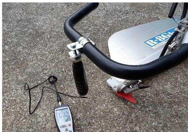
写真2 反エンジン側ハンドルに取り付けた振動計
