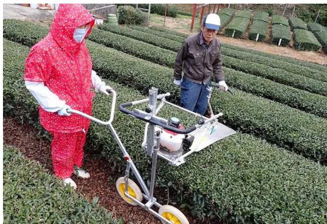
写真1 やじろべえを装着させた大型剪枝機
