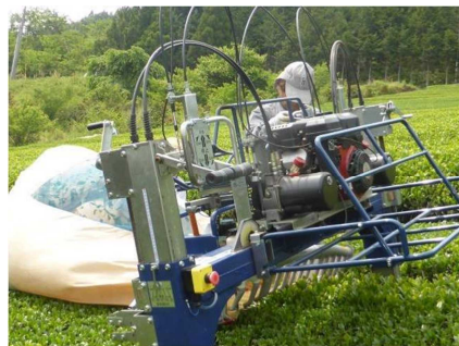
写真2 自走式管理機による摘採(左)、整枝(右)作業
