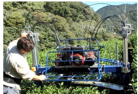
写真2 自走式管理機による摘採(左)、整枝(右)作業
