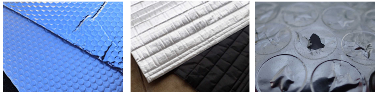
写真1 アルミプチ 写真2 EK 写真3 使用4年目のアルミプチ 表面の劣化の様子
