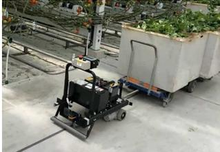
自動運搬ロボットによる残渣処理
