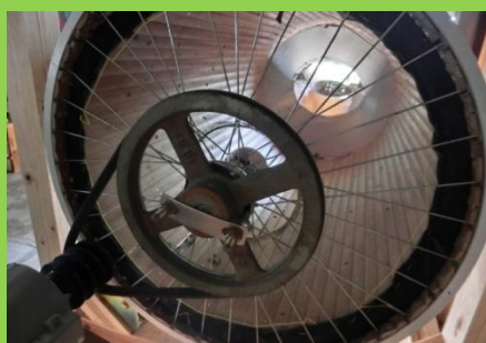
写真2 揺青機後方から見た胴内部と駆動部
