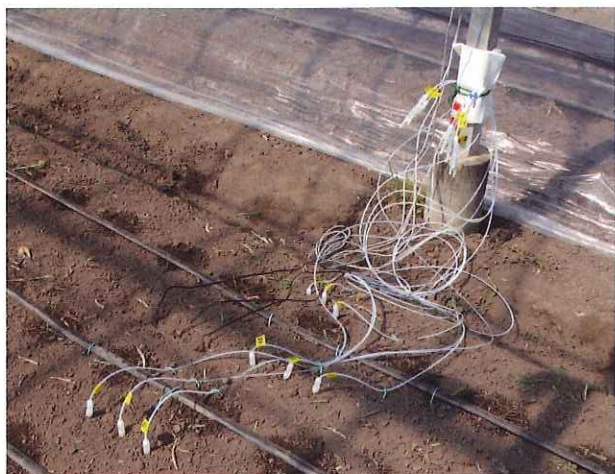
写真2 ガス採取管設置の様子
