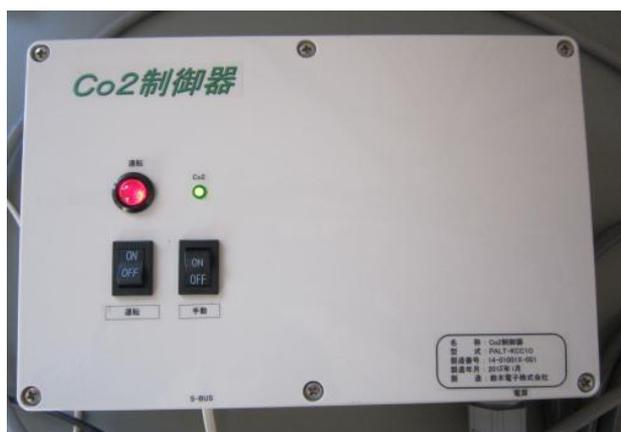
写真2 炭酸ガスコントローラー
