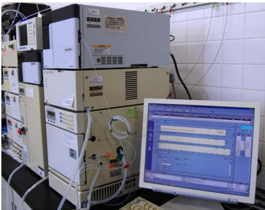
写真 図1~2を測定した液体クロマトグラフィー
