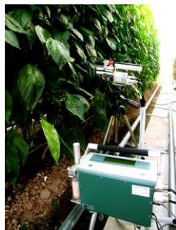
写真 光合成蒸散測定装置
