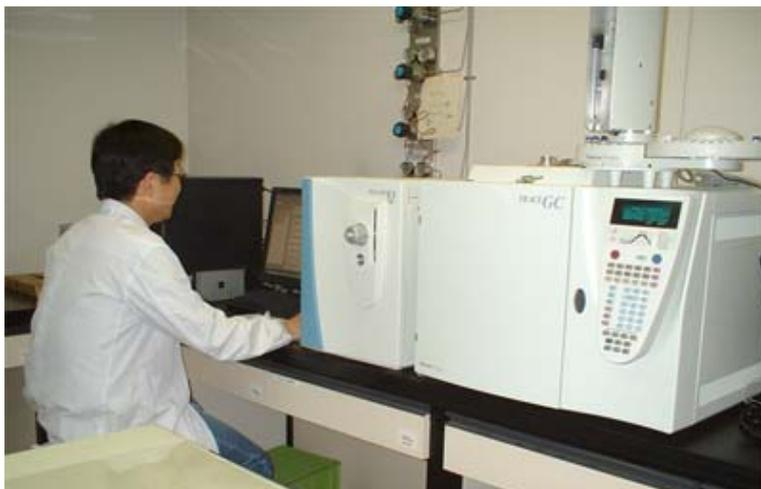
写真 ガスクロマトグラフィーによる残留農薬の分析
