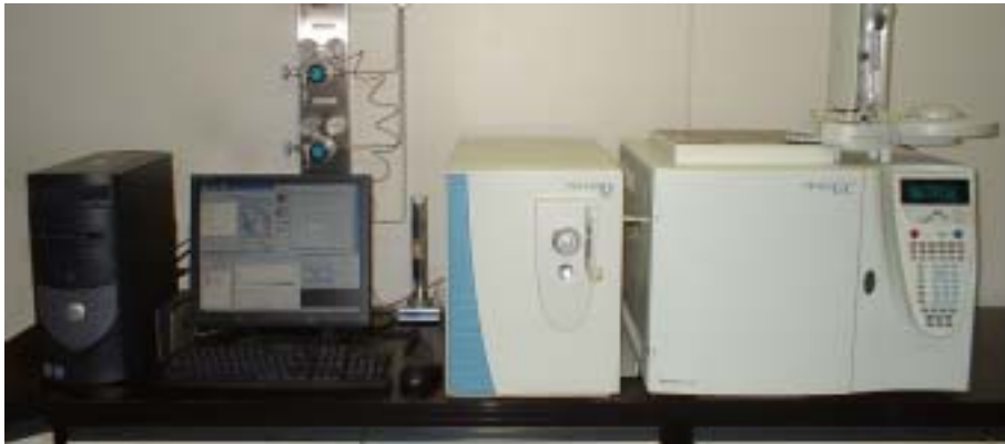
今回導入された質量分析計付きガスクロマトグラフ (GC - MS)
