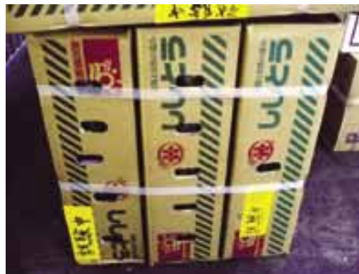
写真1 輸送試験の状況；市場のセリ場に置かれた試験品の荷姿。現行の段ボール箱（右）に対して、段ボール箱の側面の穴数を増やす（左と中）ことで腐敗果の発生を軽減できた。
