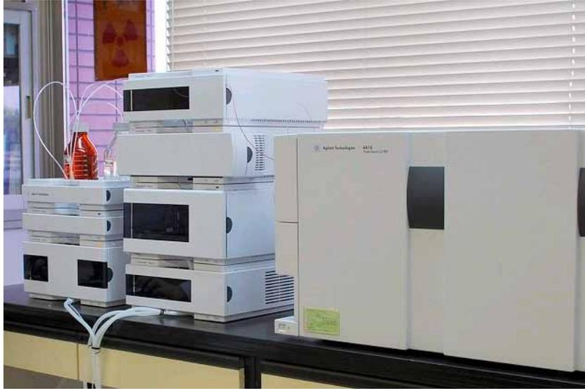
写真1 質量分析計付高速液体クロマトグラフ (LC/MS/MS)
