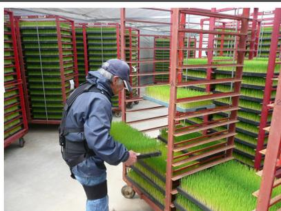
アシストスーツを着用し、苗箱を移動させる作業員
